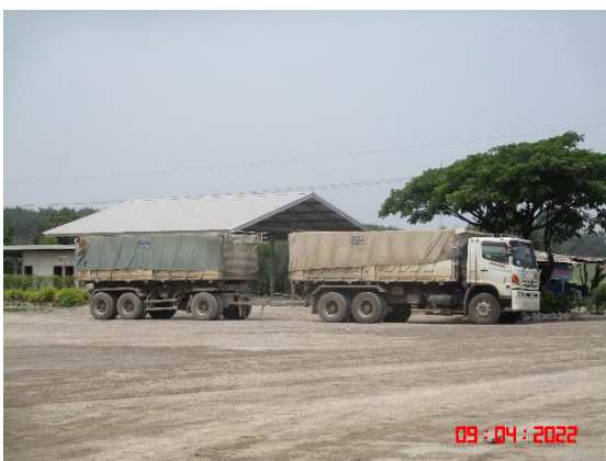
รูปที่ 2-12 การปิดคลุมผ้าใบกระบะรถบรรทุกและป้ายเตือนให้ปิดคลุมผ้าใบ
